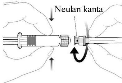
Neula kiinnitetään ruiskuun yhdistämällä neulan kanta Luer Lock -adapteriin ja kiertämällä neulaa neljänneskierros myötäpäivään, kunnes neula tuntuu kiinnittyvän ruiskuun.
