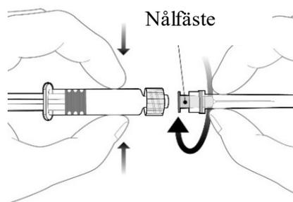
Fäst nålen på sprutan genom att ansluta den till Luer Lock kopplingen och rotera ett kvarts varv medsols tills du känner att den låser sig.
