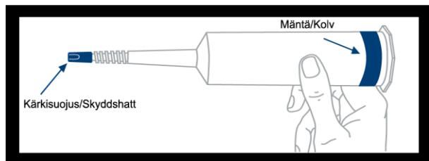
Ta bort sprutan från förpackningen och inspektera området runt skyddshatten och kolvens utsida efter tecken på läckage. Använd inte om läckage observerats. Placera sprutan i tryckmanteln.
