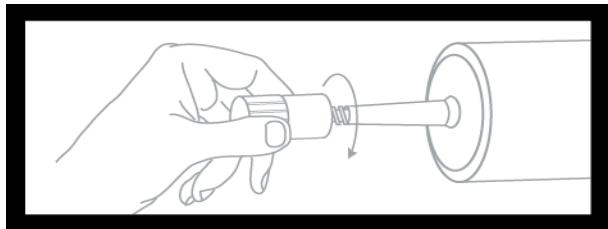
Sätt fast luer lock anslutningen på sprutan genom att hålla dammskyddet och vrid till slut. Ta bort och kasta dammskyddet när det är klart att sätta fast steril anslutningssläng.
